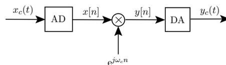
Figura 2: Esquema de modulação digital referente ao problema 9.
