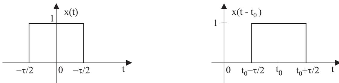
Figura 2.4: Deslocamento de um sinal no eixo dos tempos.
