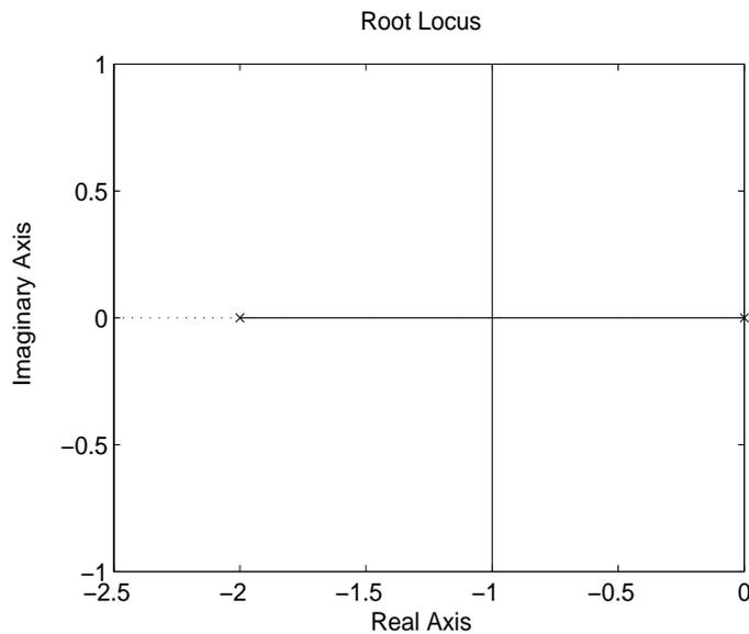
Utilizando o lugar das raízes acima, calcula-se geometricamente que os comprimentos dos vetores que ligam os pólos do sistema em malha aberta ( $p_1 = 0$  e  $p_2 = -2$ ) ao lugar das raízes em  $s_1 = -1 + j$  fornecem um valor de  $k$  como sendo:
