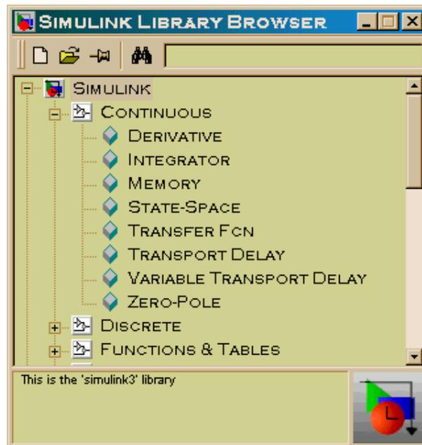
Figura 8: Janela com os blocos dinâmicos a tempo contínuo
